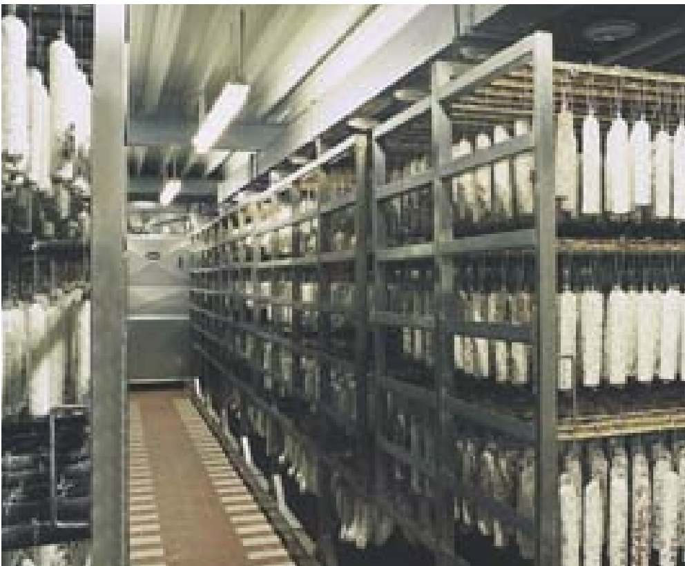
CLIMASTAR KNR - Klimanachreifeanlage für 60 Wagen
