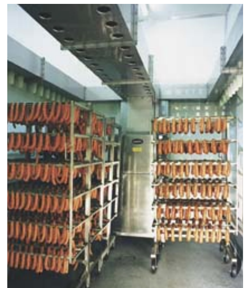
CLIMASTAR KRAI – Reifeanlage für 16 Wagen
