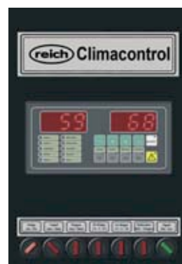
CLIMASTAR Klimacontrol MC-Steuerung mit neuestem Meßsystem für klimaoptimierte Regelung der CLIMASTAR-Anlagen
